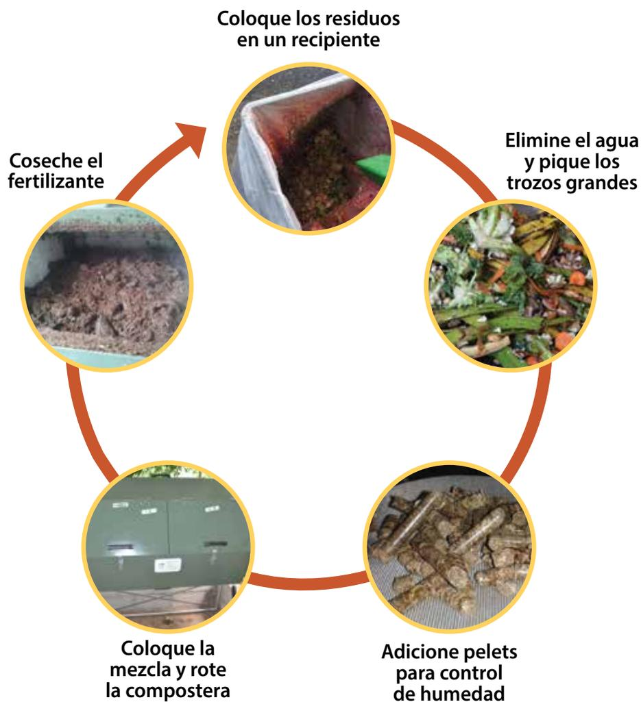
Figura 3. Diagrama del proceso de las composteras giratorias. Fuente: Elaboración propia.
