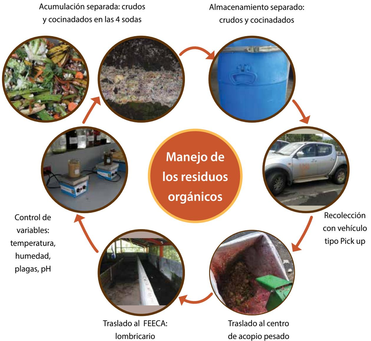
**Figura 5.** Diagrama del proceso de producción de abono orgánico por medio de lombricompostaje. Fuente: Rojas, 2011.
