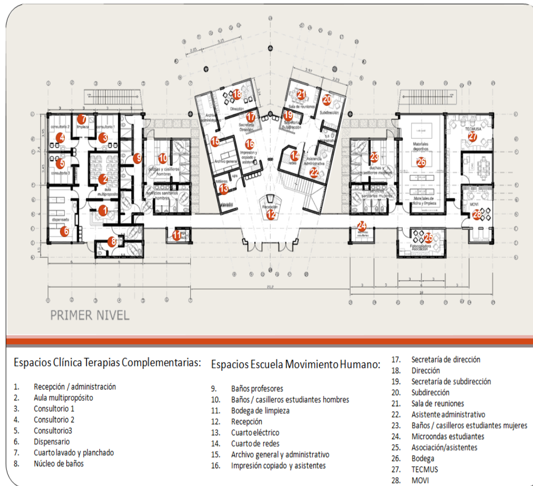
Figura 7. I NIVEL-Parte del diseño arquitectónico del proyecto Movimiento Humano y Terapias Complementarias. Campus Benjamín Núñez. Fuente: UCPI, PRODEMI, 2015.
